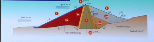
SECCIÓN TIPO EN CAUCE (P1/P5 Y P9/P14)
